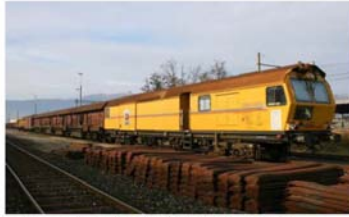
Train meuleur de rails (Scheuchzer S.A.)
